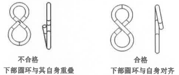
图A.1 S型连接件示例图
