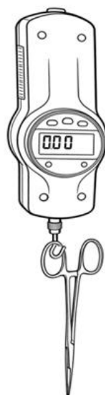
图 B.1 单簇草丝拉出力检测装置示意图
